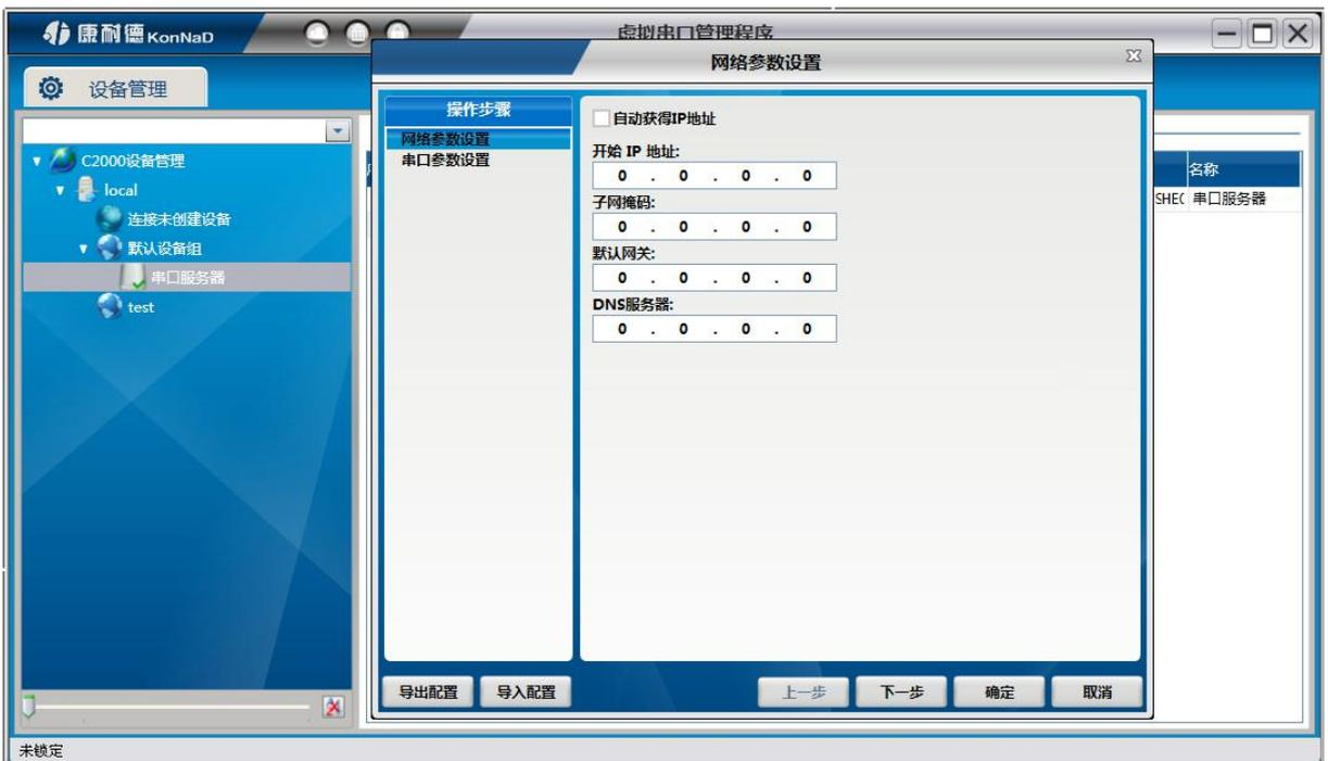
点击“下一步”可进入串口参数设置，当设备为多串口时，批量设置串口参数可达到方便快捷的作用。
