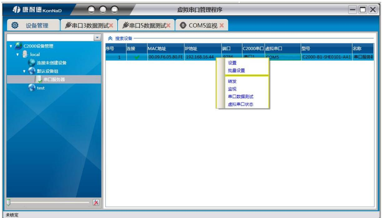
转发：设置串口的转发状态
