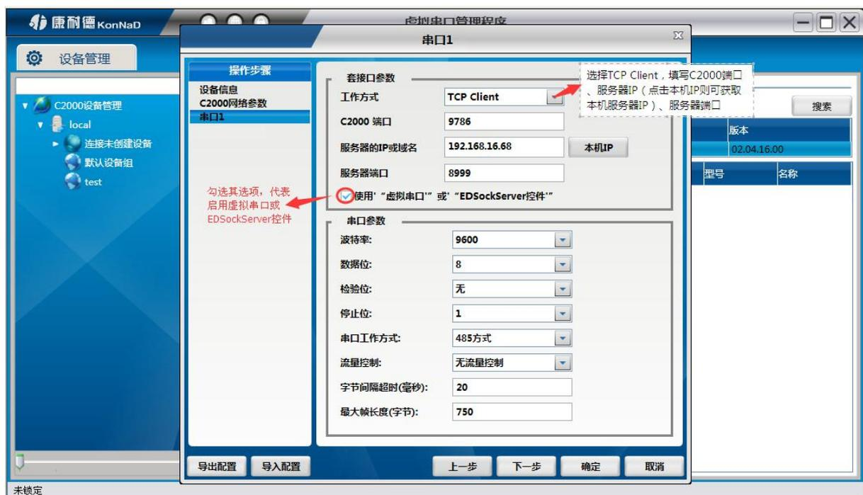
注：C2000 端口及服务器端口需与平台设置服务器监听端口一致
