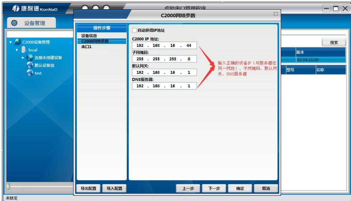
如果勾选“自动获得 IP 地址”，那么此 C2000 所在网段当中的 DHCP 服务器将为其自动分配 IP 地址，但仍需手动设置上本网段默认网关；否则，需要为其指定 IP 地址和子网掩码、默认网关。
